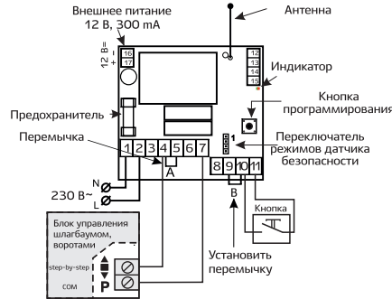
Рис. 1 — Подключение блока автоматики
